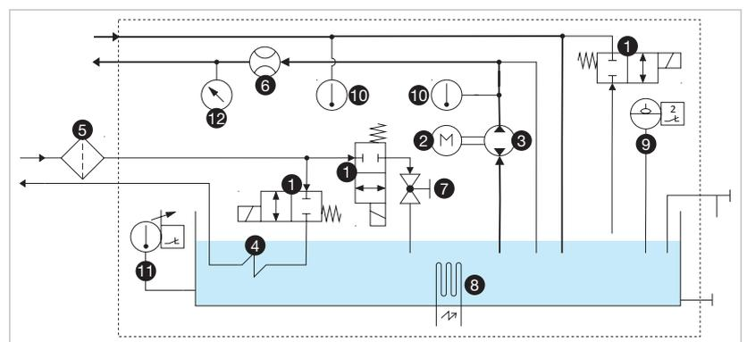
1 2-2 Wege Ventil (Normal geschlossen), 2 Pumpenmotor, 3 Pumpe mit umkehrbarer Pumprichtung, 4 Kühlwendel, 5 Filter, 6 Durchflusssensor, 7 Kugelventil, 8 Heizelement, 9 Füllstandsensor, 10 Temperaturfühler, 11 Sicherheitstemperaturbegrenzer, 12 Drucksensor
