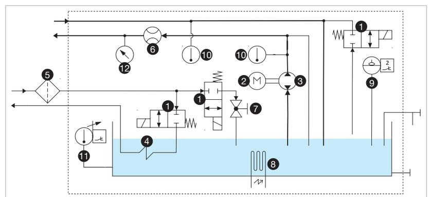
1 2-2 Wege Ventil (Normal geschlossen), 2 Pumpenmotor, 3 Pumpe mit umkehrbarer Pumprichtung,
