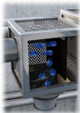
Závěrečný odluvač ukončí přesně dopravní cestu
